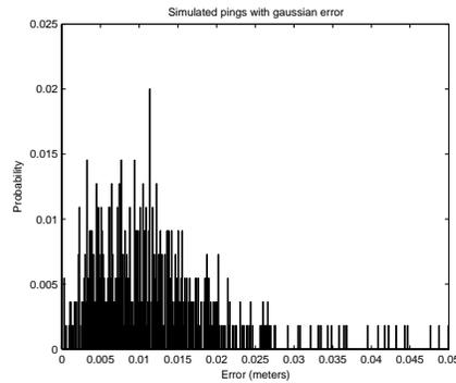
(d) Simulated Pings: Gaussian Error
